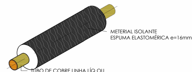
DETALHE TÍPICO REVESTIMENTO TUBULAÇÕESDE COBRE LINHA LÍQUIDO E SUÇÃO
